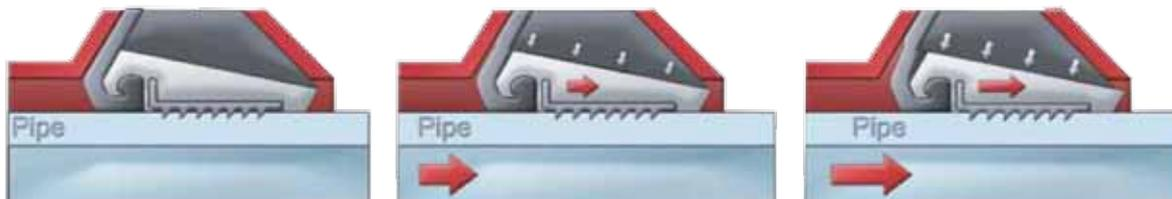
Incrementando le forze assiali sulla tubazione si incrementa l'effetto di tenuta e di grip del sistema.
