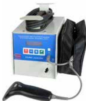
La saldatrice modello Euro Junior è una macchina polivalente idonea alla saldatura di tutti i raccordi elettrosaldabili fino al diametro d.160. Consente all'operatore di lavorare con tensione antinfortunistica inferiore a 50 Volt ed è stata costruita in conformità alle norme UNI 10566 e ISO 12176-2, nonché provvista di marchio CE.
