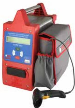
La saldatrice modello Euro SP1 plus è una macchina polivalente idonea alla saldatura di tutti i raccordi elettrosaldabili fino al diametro d.710. Consente all'operatore di lavorare con tensione antinfortunistica inferiore a 50 Volt ed è stata costruita in conformità alle norme UNI 10566 e ISO 12176-2, nonché provvista di marchio CE.
