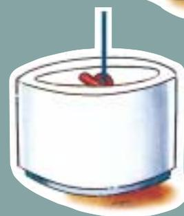
Nella parte superiore dell'elemento di rialzo monolitico, e di quello intermedio, sono presenti due sedi per l'alloggiamento di una barra telescopica in acciaio per il sollevamento.
